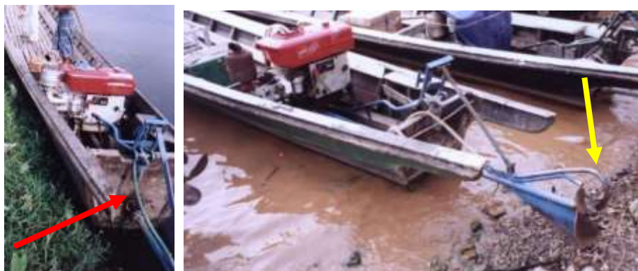
1.1.22. ábra: Burmai „long-tail” hajtásrendszer
