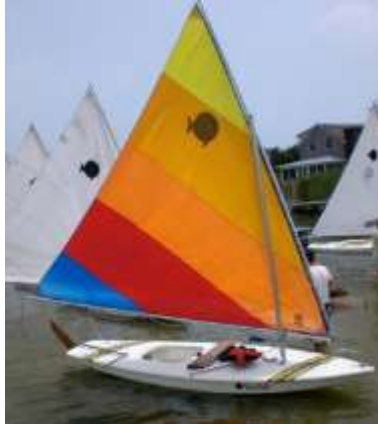
2.1.3. ábra: Sunfish típusú kishajó latin vitorlával
