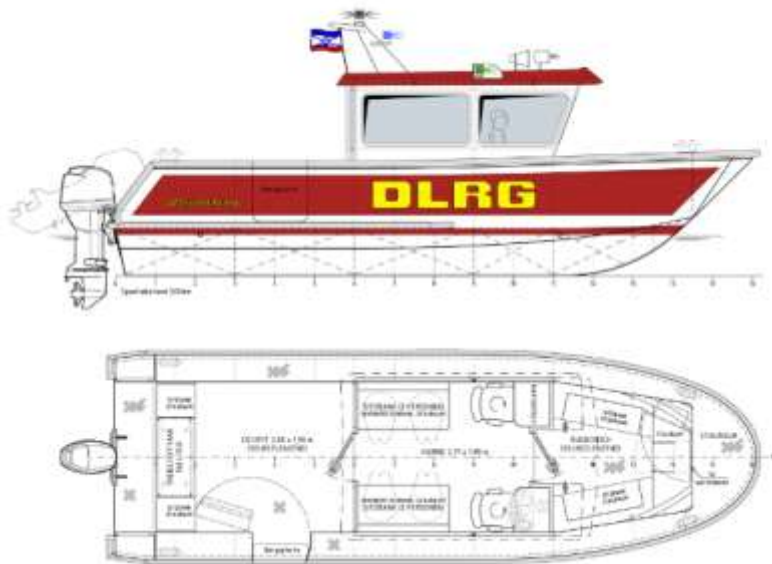
1.1.8. ábra: 8 m-es mentőhajó külmotorral felszerelve
