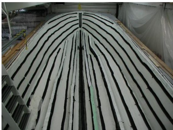
8.1.16. ábra: A sablonba bekerültek a gyantavezetők a tépő-szövet és a száraz laminát fölé
