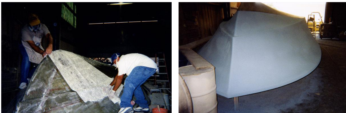
8.2.5. ábra: A kikötött C-Flex lelaminálható, majd következhet a gittelés-csiszolás
