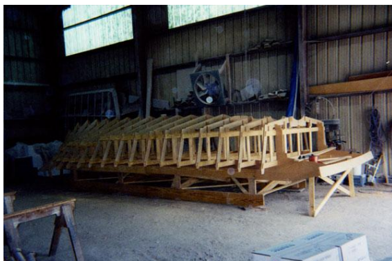
8.2.3. ábra: Az elkészült vázszerkezet és az első réteg C-Flex felvitele
