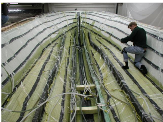
8.1.20. ábra: Amint a gyanta elér egy újabb csatornát, az előzőt lezárják, azt meg kinyitják
