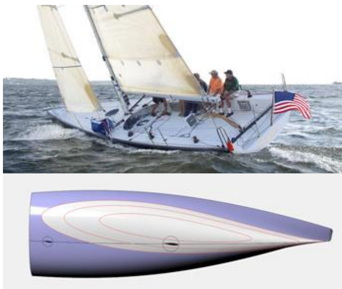
4.3.5. ábra: Kerek bordametszetű vitorlás vízvonalai megdőlt helyzetben is szimmetrikusak maradnak
