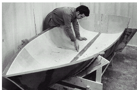
8.2.9. ábra: Bölcső készítése és az élek rézselése belül
