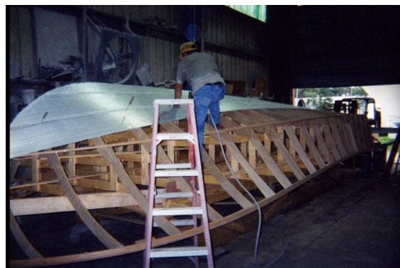
8.2.3. ábra: Az elkészült vázszerkezet és az első réteg C-Flex felvitele
