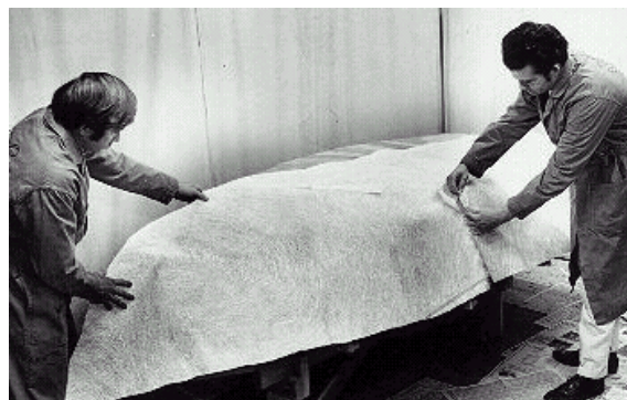
8.2.7. ábra: A hab táblák rögzítése és az üvegszövet méretre szabása
