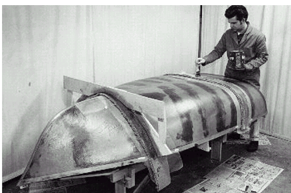
8.2.9. ábra: Bölcső készítése és az élek rézselése belül
