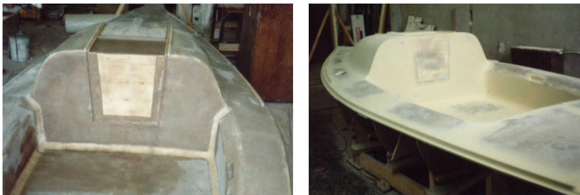
8.1.2. ábra: Az ősminta szerkezete üvegszál-as poliszter laminát bevonattal (balra) és sok gittelés-csiszolás fázis után (jobbra)
