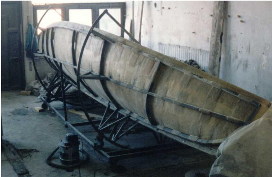
8.1.6. ábra: Kishajó elfordítható sablonja, acélszerkezet merevítéssel
