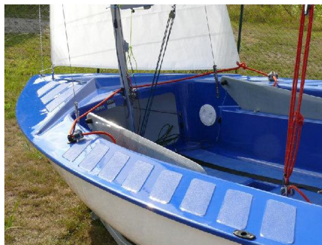
5.2.10. ábra: Klasszikus jolle csap körül elfordítható uszonnal
