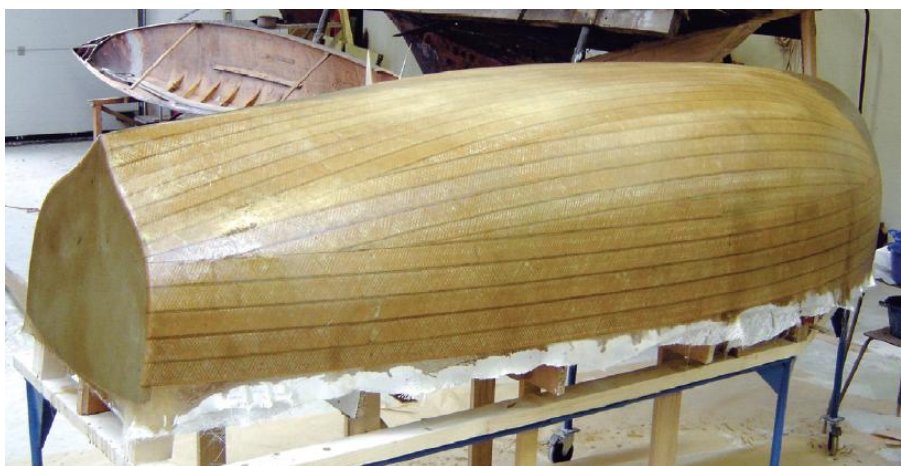
8.2.11. ábra: Easy-Plank® és a belőle készített csónak
