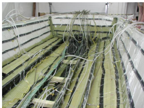
8.1.20. ábra: Amint a gyanta elér egy újabb csatornát, az előzőt lezárják, azt meg kinyitják
