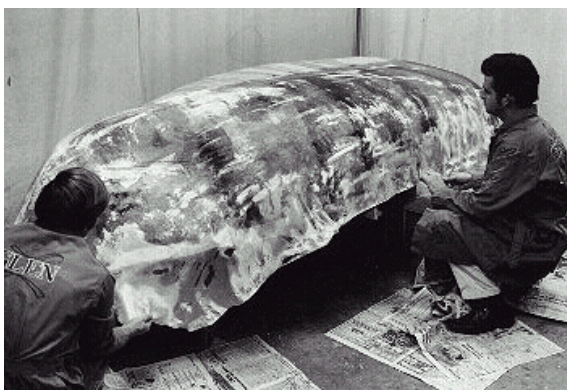
8.2.8. ábra: A külső rétegek laminálása
