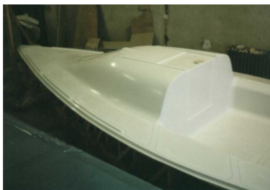
8.1.3. ábra: A végleges felületképzés után elkészült ősminta
