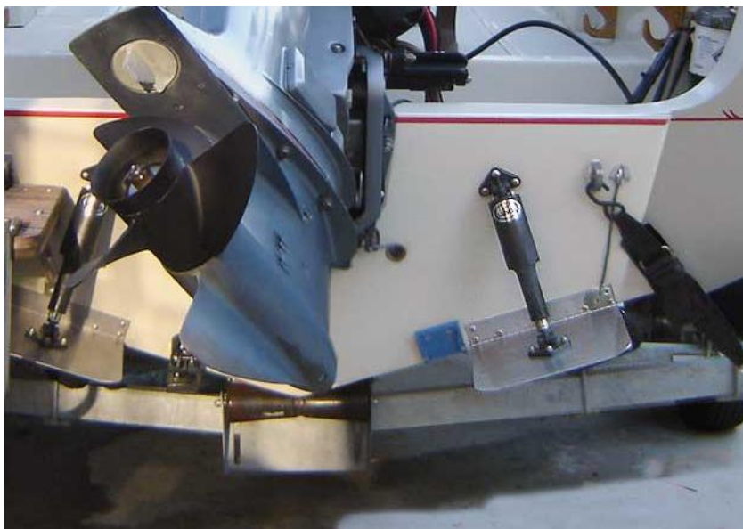
4.3.14. ábra: Trimlap egy motorcsónak tükrén
