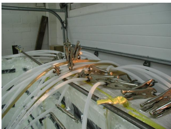
8.1.18. ábra: Bekötik a gyantabevezető csatornákat, majd elindítják az infúziót
