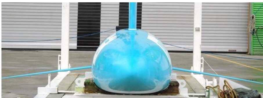
5.6.4. ábra: Egy America's Cup hajó bulbája a szárnyakkal
