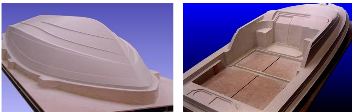
8.1.4. ábra: 5-tengelyes CNC maróval készített ősminták
