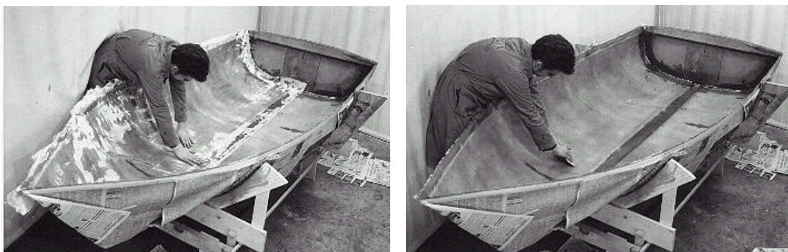
8.2.10. ábra: A belső laminát elkészítése kézi laminálással
